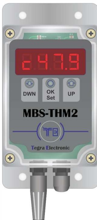
سنسور دما و رطوبت مودباص مدل MBS-THM2 یک سنسور دیجیتال صنعتی بوده که قابلیت اتصال به انواع سیستم های کنترلی، PLC ها و دیتالاگر ها را دارا می باشد. دقت بالا، رنج مناسب، قابلیت کالیبرا سیون دقیق و تنوع خروجی های دستگاه، آن را به گزینه‌ی مناسبی برای انواع محیط های صنعتی و آزمایشگاهی تبدیل نموده است.
